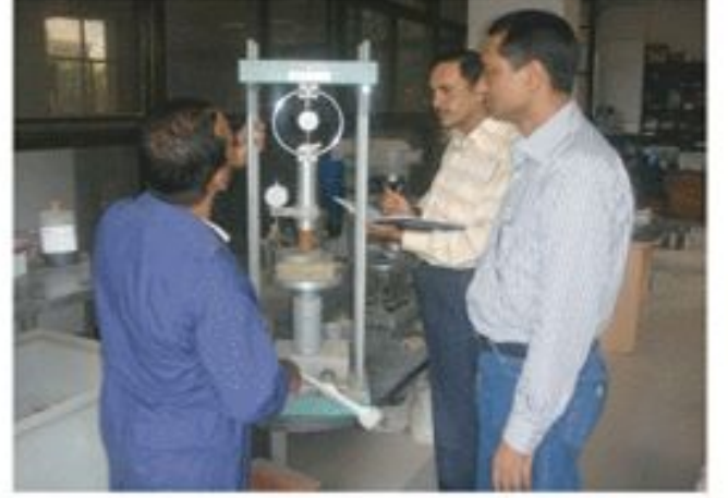
Laboratory তে Un-confined Compression পরীক্ষা করা হচ্ছে।
