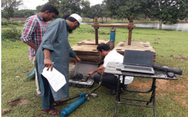
Plate Load Compactor এর সাহায্যে মাটির Bearing Capacity নির্ণয় করা হচ্ছে।
