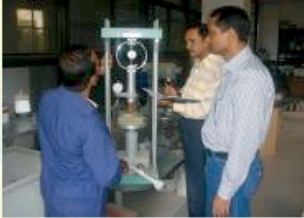
Laboratory তে Unconfined Compression Test দ্বারা মাটি পরীক্ষা করা হচ্ছে।
