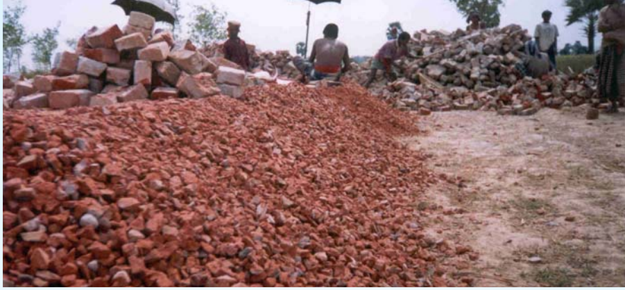
চিত্র-৩২ ইট ভালো তবে খোয়ার আকার অনেক বড় এবং ঢালাইয়ের উপযোগী না (ঢালাইয়ের উপযোগী খোয়া সর্বোচ্চ ৩/৪" বা ২০ মিমি সাইজের হবে)
