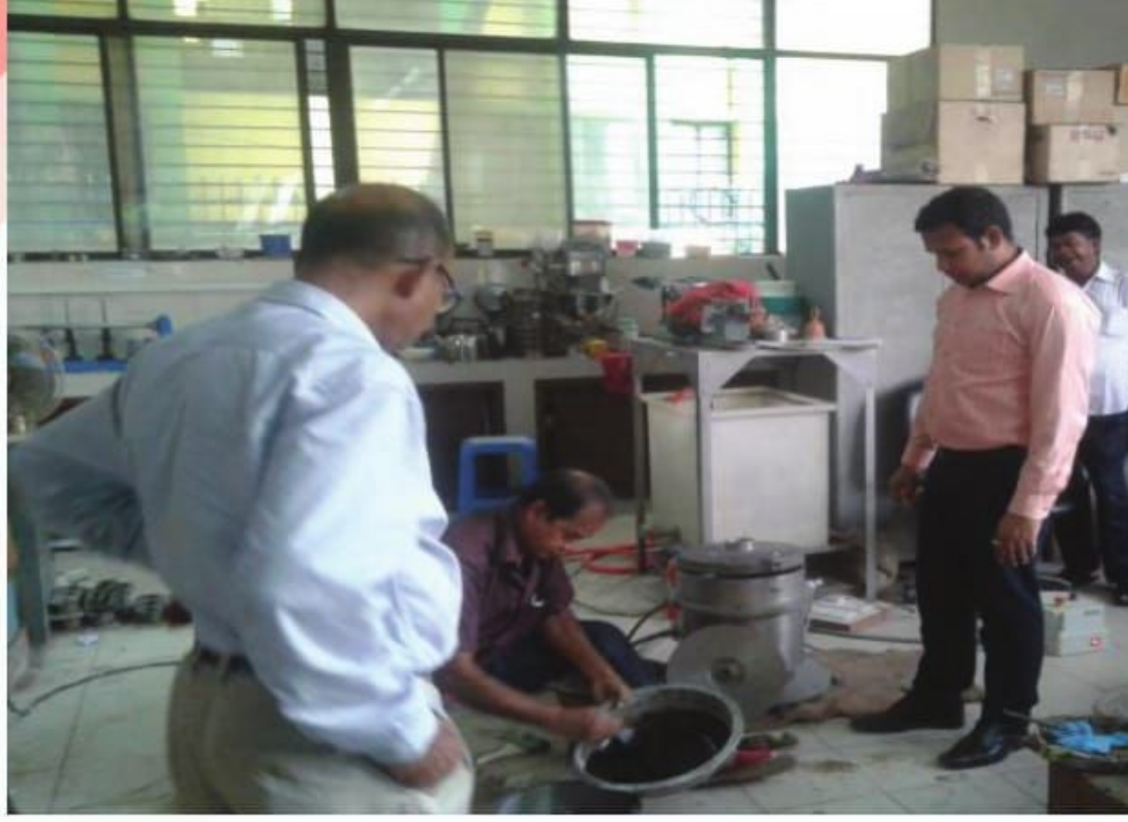
Laboratory তে Bitumen Extraction Test করা হচ্ছে।
