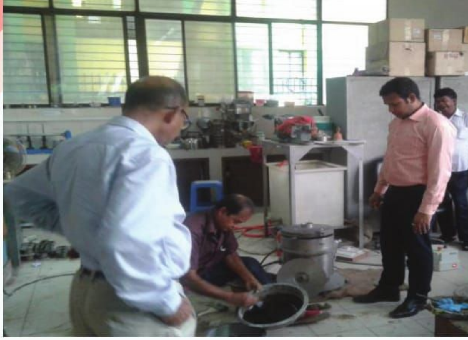
Laboratory তে Bitumen Extraction Test করা হচ্ছে।
