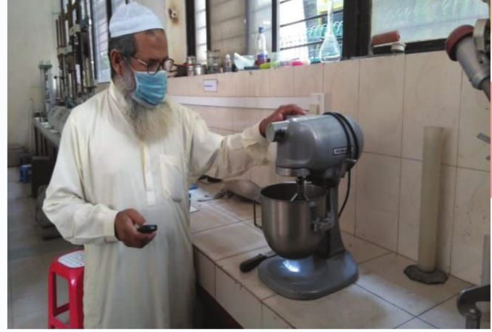
Laboratory তে Cement Test করার জন্য Mortar প্রস্তুত করা হচ্ছে।
